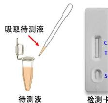
(3) 垂直滴加到检测卡的加样孔中；液体流动时开始计时，8~10 分钟进行结果判定，其他时间判定无效。
